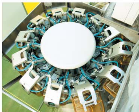
▲大量ロットを可能にする大型自動計量充填機。 1時間で6,000袋真空パック詰め可能です。
